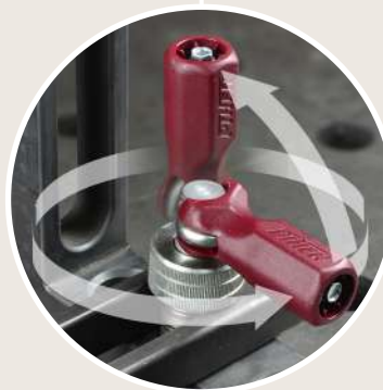
Serre-joint avec manche interchangeable, ergonomique et multiposition.
