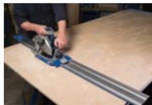
La piste reste en place sur vos marques grâce à une surface anti-copeau et antidérapante sur la partie inférieure de la Barre de guidage, ainsi nul besoin de serre-joint pour réaliser la plupart de vos coupes. Des pincés optionnels (ci-dessous) sont disponibles pour utiliser cet outil sur les matériaux avec une surface glissante, comme la mélamine ou le contreplaqué pré-fini.
