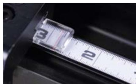
Amplifié et facile à lire même pour les plus petits ajustements, le Curseur à lentille de précision vous permet de régler le bras pour découper du contreplaqué, des tenons, et plus encore.
