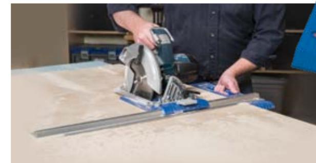
Pas besoin de mesures ou de marques grâce à l'échelle de mesure et au curseur de précision intégrés. Verrouillez simplement la taille de votre coupe et allez-y.
