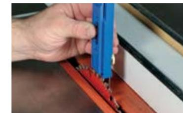
Régler la hauteur des mèches et des lames.
