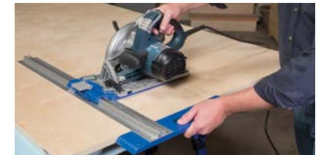
Les coupes droites sont faciles grâce à un guide de bord surdimensionné doté d'une poignée assurant un contrôle tout le long de la découpe en suivant le bord de votre plaque.
