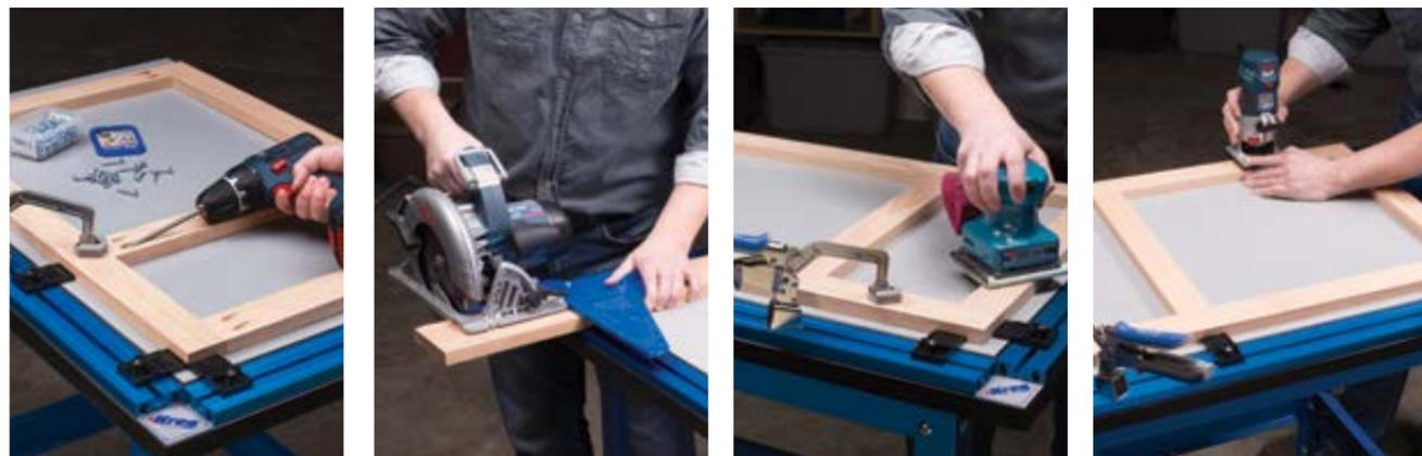
La table à pinces maintient les pièces en toute sécurité et fournit un support solide pour la menuiserie Kreg,™ le perçage, le sciage, le ponçage, le défonçage et bien plus encore !
