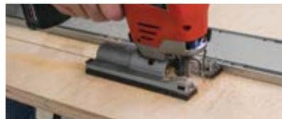
Rail de guidage en aluminium dirigeant des coupes avec précision en suivant une ligne droite.
