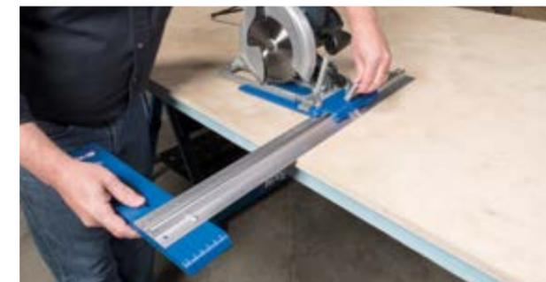
Faites des ajustements rapides et précis en faisant simplement glisser la scie le long du rail, puis verrouillez-la. Pas d'outils nécessaires. La glissière fonctionne aussi avec l'Accu-Cut™
