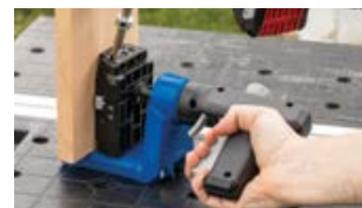
Gabarit polyvalent qui permet de créer des joints dans les matériaux de 13 mm à 38 mm d'épaisseur.
