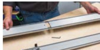
Rail de guidage en aluminium dirigeant des coupes avec précision en suivant une ligne droite.
