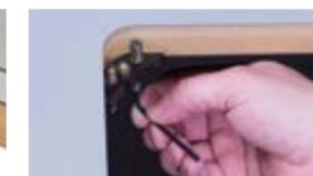
Deux vis de réglage sur chaque niveleur permettent d'aligner facilement la plaque de la toupie avec la surface de la table.
