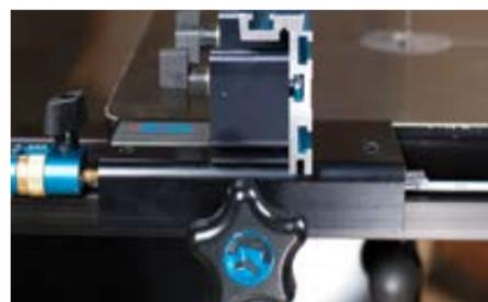
Réglez le bras de manière précisément perpendiculaire à la surface de votre table et ajustez l'angle pour compenser la dérive de la lame avec les vis de fixation qui s'ajustent simplement et tiennent fermement pour des résultats fiables.
