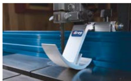
Ajoutez un Swing Stop™ ou un Stop de production au bras qui facilite la réalisation de coupes précises et reproductibles d'une profondeur définie, par exemple celle nécessaire à la découpe de tenons.
