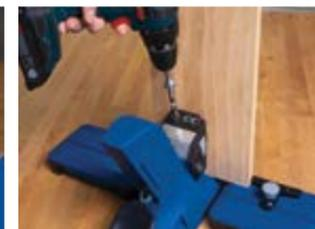
Le gabarit multi-fonctions permet de créer des joints pour trou de poche dans des matériaux de 13 à 38 mm d'épaisseur.
