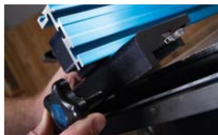
Enlever le bras en quelques secondes, sans avoir besoin d'outils ! Il suffit de desserrer le bouton de verrouillage et de soulever le guide du rail de montage. Le rail se situe hors de portée de la surface de la table.
