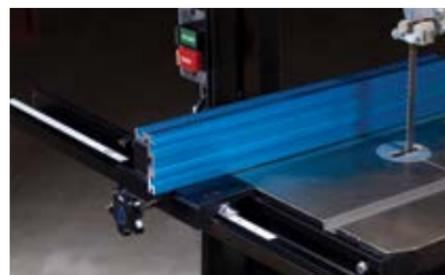
Le bras en aluminium est incroyablement fort, droit et conçu pour durer longtemps. Les bords du devant et du dessus du bras comprennent des rainures en T pour ajouter des arrêts, rails de guidage, et plus.
