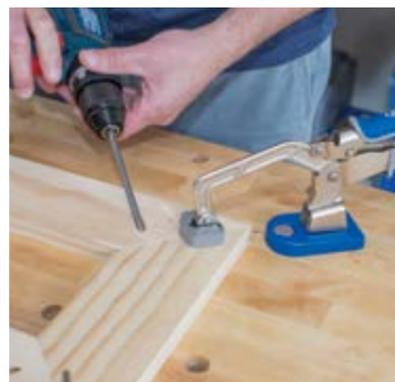
La pince d'établi permet de maintenir les pièces parfaitement alignées pour créer des joints bien ajustés.
